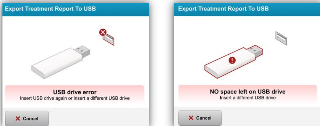
Abbildung 3-42. „USB-Laufwerksfehler“ (USB Error) und „Kein Platz mehr auf dem USB-Laufwerk“ (No Space Left on USB)
