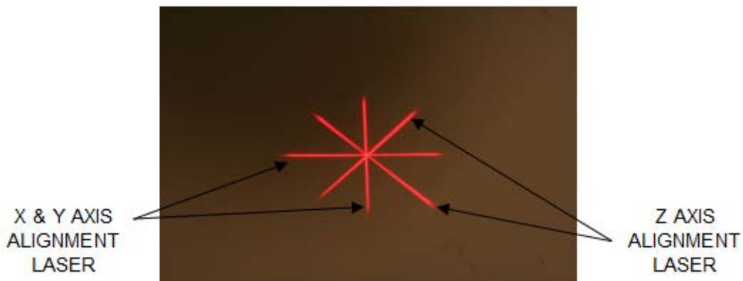
Figura 3-24. Alinhamento das miras vermelhas dos eixos X e Y, miras vermelhas do eixo Z
