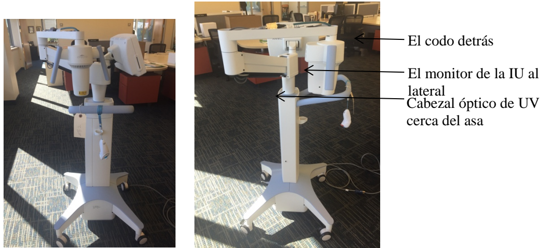
Figura 4-2 Desplazamiento de la configuración del sistema
