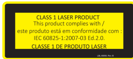
Figura 2-6. Etichetta di classificazione del laser
