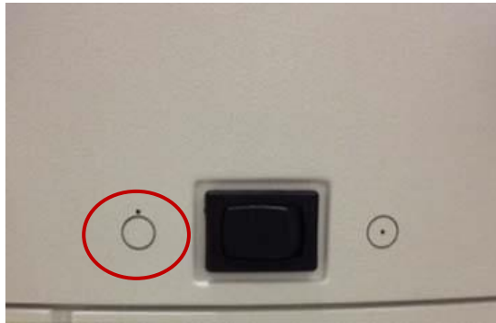
Figura 3-31. Interruttore in posizione "Spento" (OFF)
