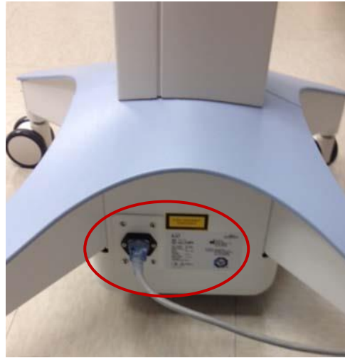
Illustration 3-32. Fiche d'alimentation du système KXL
