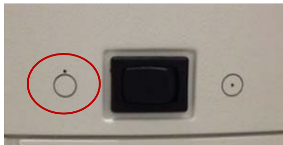
Figure 3-29. Position Arrêt de l'alimentation
