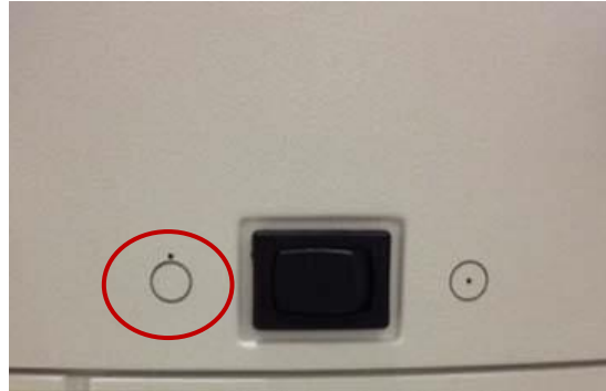
Figura 3-31. Posición de apagado
