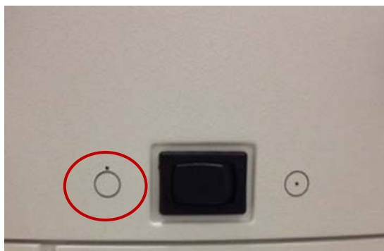
Figura 3-31. Posición de apagado
