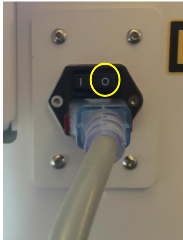
Figura 3-49. Posición de apagado
