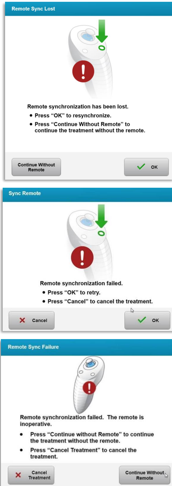
Afbeelding 4-2. Synchronisatie afstandbediening voor uitlijning verloren – Oorspronkelijke afstandbediening
