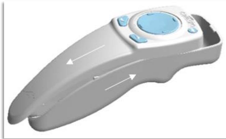
Obrázok 4-1. Prístup do priehradky s batériami
