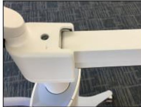
Εικόνα 4-7. Ρύθμιση τάσης βραχίονα με τη βίδα προσαρμογής ισχύος C
